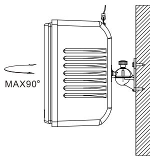
7.Si une sangle de sécurité doit être installée, veuillez utiliser la vis KA4 \* 15 pour la fixer au haut-parleur comme indiqué ci-dessous.
