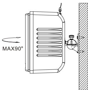
7.Si es necesario instalar una correa de seguridad, utilice el tornillo KA4\*15 para fijarla al altavoz como se muestra a continuación.
