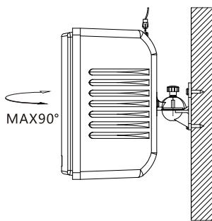
7、如需要使用安全绳，可以使用KA4\*15螺钉将安全绳固定在设备上。
