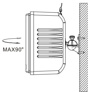
7.Se è necessario installare un cinghia di sicurezza, utilizzare la vite KA4-15 per fissarla all'altoparlante come illustrato di seguito.
