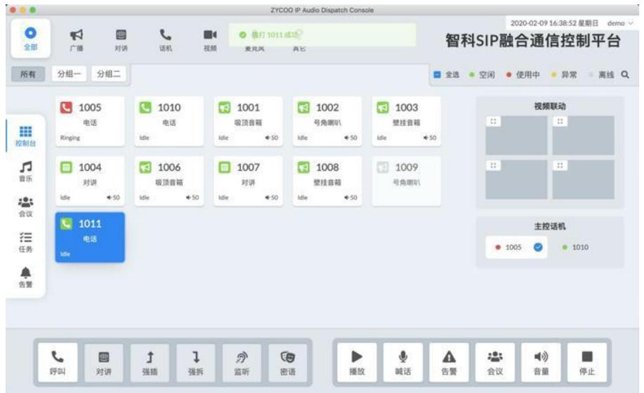
主控话机摘机后，将对选中话机发起呼叫，建立起呼叫连接后，被叫和主控话机都处于使用中的状态，如右图所示。
