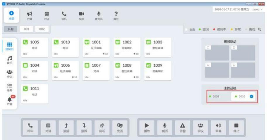
主控话机接听来电时的优先级为：左侧话机高于右侧话机。如果有来电呼叫操作员的任意主控话机号码时，优先级高的话机会优先响铃（如振铃策略为【同时振铃】时，所有的主控话机将会同时振铃）。
