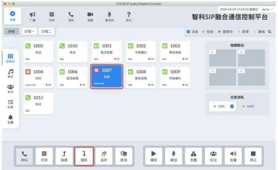
主控电话响铃并摘机后，将建立与选中的目标号码的通话，并将另一方挂断。
