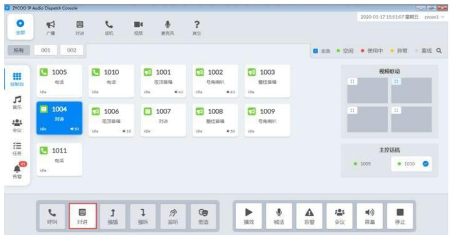
对讲通话建立后，若对讲终端带摄像头或关联了IP摄像头，在右侧视频联动窗口会显示对方摄像头获取到的实时视频画面，实现视频联动。
