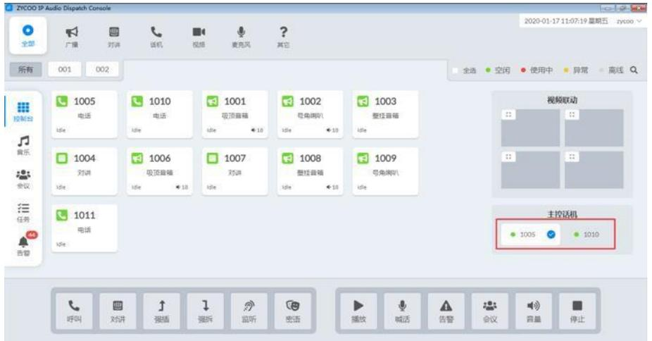
当操作员登录时，默认左侧话机为操作员的主控话机（外呼时默认使用的话机）。操作员可以调整自己的默认主控话机，只需点击选中另一个话机即可修改默认主控话机。
