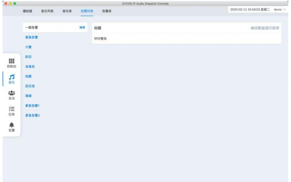
SIP 融合通信系统中预先默认设置了一系列告警事件列表，用户可对这些紧急事件对应的告警音进行修改。通过【编辑】按钮可以修改对应的告警内容。
